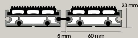
Zerbino tecnico composto da profili portanti in alluminio estruso antitorsione correddati da apposita guarnizione fonoassorbente nel lato inferiore.
